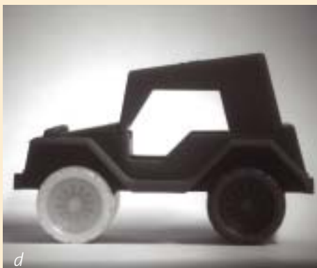
Bild 4: Unterschiedliche Farbauswertungen an Hand eines einfachen Beispiels eines falsch montieren, gelben Rades an einem blauen Spielzeugauto. a) Farbbild (RGB), b) monochromes Bild (Grauwerte) c) blauer Kanal des Farbbildes: Auto ist hell, gelber Reifen dunkel d) grüner Kanal des Farbbildes: Auto ist dunkel, gelber Reifen ist hell
