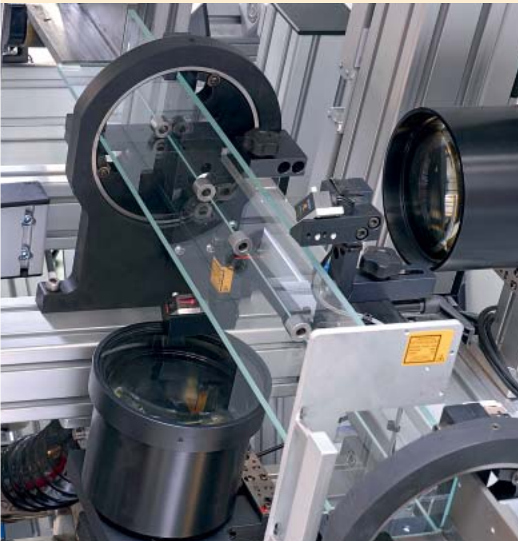
Bild 1: Detailansicht einer Anlage visiSort-S zur maßlichen und attributiven Inspektion und Sortierung. Die Anlage ist mit 2 telezentrischen Kamerastationen ausgerüstet.
